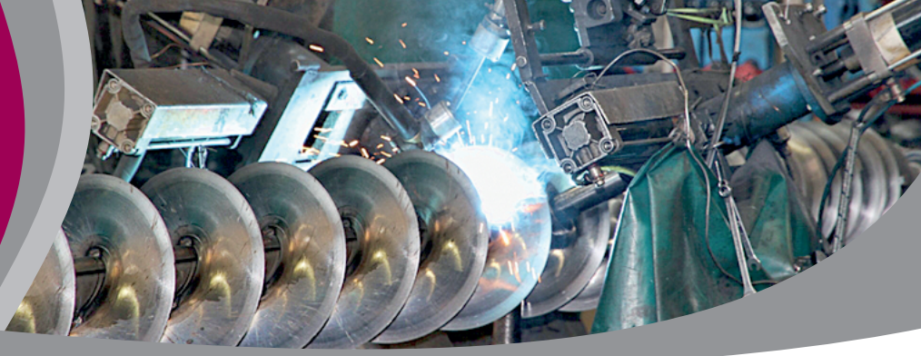
Boruya Kaynaklı Helezon Krom ve Siyah Carbon Steel Or Stainless Steel Screw Flight Welded On Shaft / Pipe حلزون النقل ملحوم على بوري معدني
